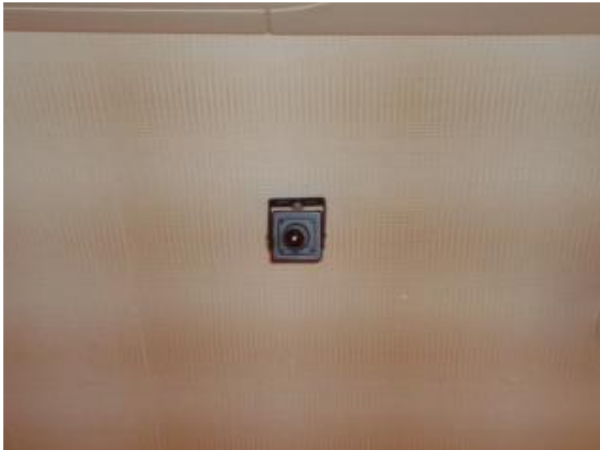
入口ドアにマグネットセンサー、店内に威嚇しないよう、ファッションブルカメラ設置
